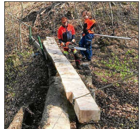
Mit der Motorsäge verwandelt Forstunternehmer Herbert Bochsichler den Baum in einen Balken.
